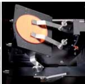
▲ Accessoire de réflexion à angle variable
