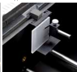
▼ Support d'échantillon solide
