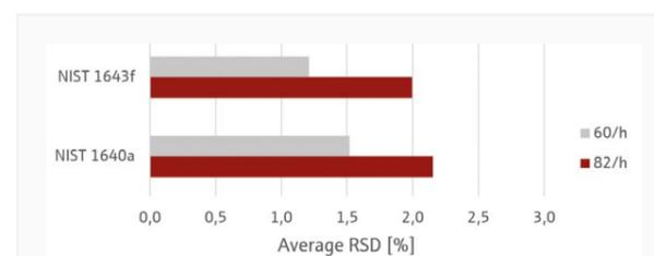
Trinkwasseranalyse nach U.S. EPA 200.8. Die RSD zertifizierter Referenzmaterialien wurde mit zwei verschiedenen Geschwindigkeiten gemessen. Die hervorragende Empfindlichkeit ermöglicht die Analyse von >80 Wasserproben pro Stunde mit hoher Präzision.
