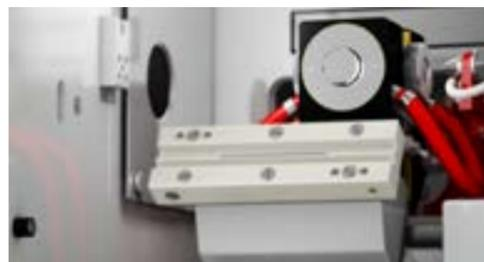
contrAA 800 D mit Flammen- und Graphitrohrtechnik in einem Probenraum
