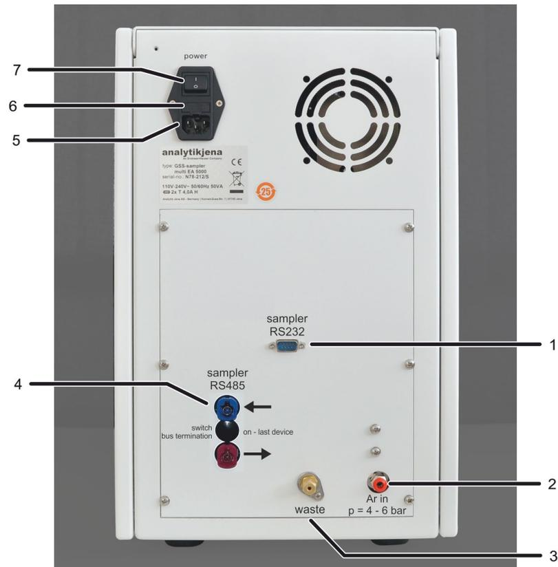
**Bild 7** Geräterückseite des GSS Moduls mit Schnittstellen und Geräteschalter
