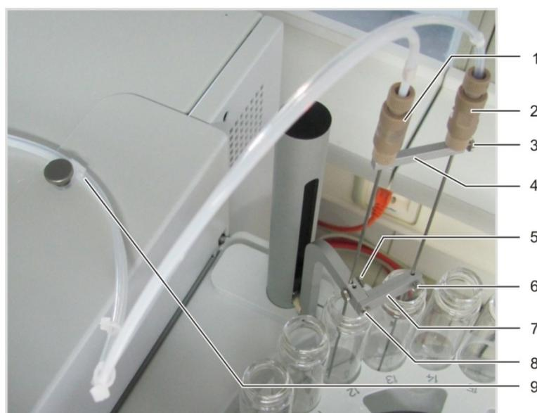
Fig. 21 Le port-canule pour la fonction "Ejection parallèle"
