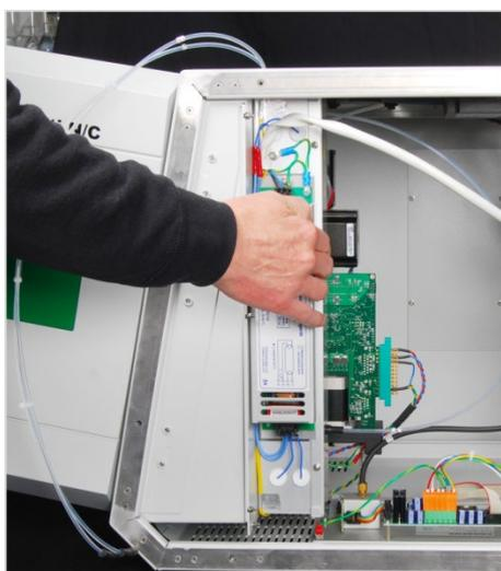
7. Tenez avec la main droite le module UV à l'intérieur de l'analyseur et dévissez avec la main gauche les vis de fixation situées au-dessus et au-dessous du verre de protection UV (1 et 4).
