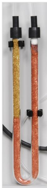
Fig. 11 Piège à halogènes
