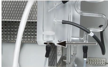
1. Schieben Sie den Gummiring auf den unteren Stützen des Kondensatgefäßes. Er schützt das Glasgefäß bei der Auflage auf den Metallhalter der Trägerplatte.
