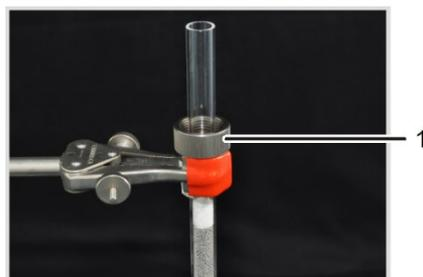
Montieren Sie den Ofenkopf auf das Verbrennungsrohr:
