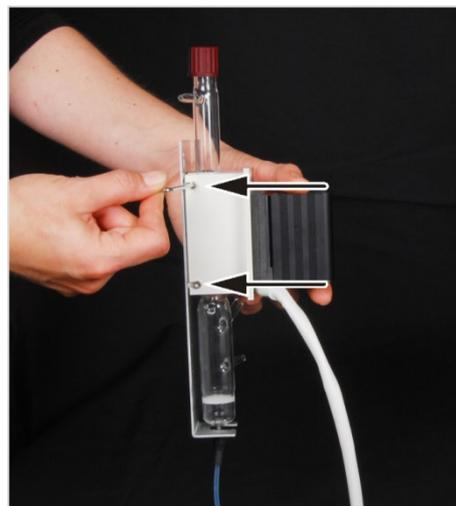
11. Schrauben Sie den Peltierkühlblock seitlich mit 4 Schrauben von der Einlegeschale für das TIC-Gefäß ab.
