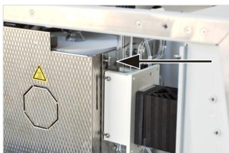
6. Entfernen Sie die Rändelschraube zur Befestigung der Trägerplatte.
