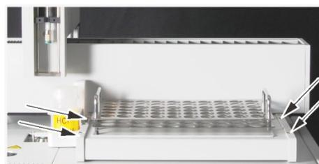
2. Befestigen Sie den Probengeber mit den beiliegenden Innensechskantschrauben oben auf dem Gehäuse des multi N/C 2100S an den dafür vorgesehenen Stellen abwechselnd mit einem Sechskantschraubendreher.
