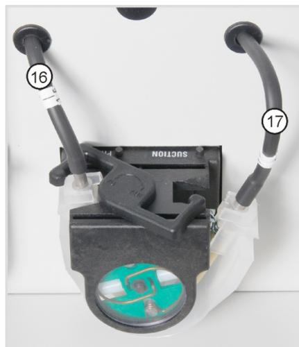
2. Drücken Sie den Bügel an der Kondensat-Pumpe nach links.
