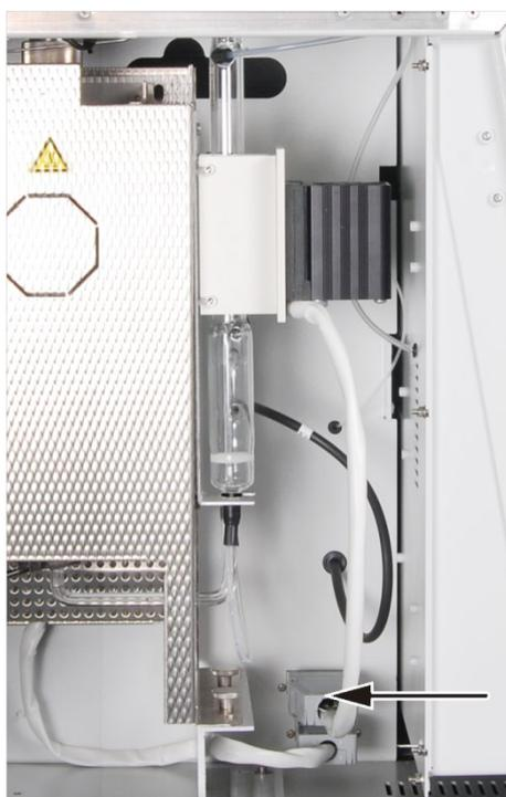
7. Ziehen Sie den Stecker des Peltierkühlblocks aus dem Anschluss an der hinteren Wand an (siehe Pfeil).
