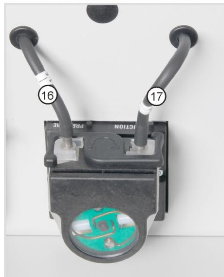
9. Legen Sie das Laufband um den Pumpenkörper.
