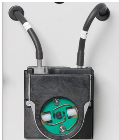
Abb. 7 Kondensat-Pumpe
