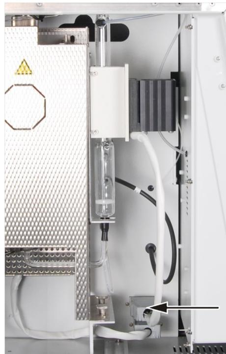
6. Hängen Sie die Trägerplatte in die Aufhängung auf der rechten Ofenseite. Der Kugelschliffanschluss der Kondensatschlange ragt dabei in den Durchbruch des Verbrennungsofens.
