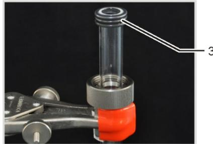
3. Schieben Sie die drei ummantelten Dichtringe (3) auf das Verbrennungsrohr.
