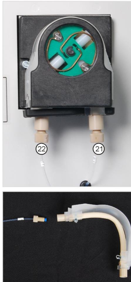
Bauen Sie den Pumpenschlauch analog dem Ausbau für die Kondensat-Pumpe aus und prüfen Sie ihn auf Dichtheit.
