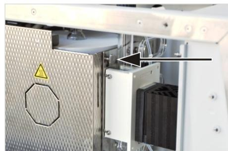
8. Befestigen Sie die Trägerplatte mit der Rändelschraube am Verbrennungsofen.
