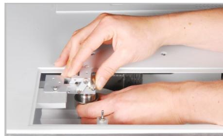
6. Schrauben Sie die Schleuse mit der Innensechskantschraube locker am Halter an.
