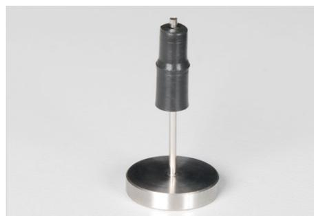
1. Schieben Sie den FAST-Verbinder auf die Kanüle der Einfädelhilfe. Die engere Bohrung des Verbinders weist dabei nach oben.
