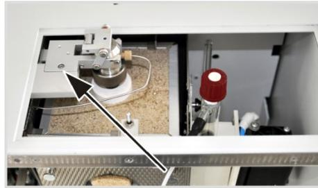
4. Lockern Sie die Innensechskantschraube an der Schleusenhalterung.
