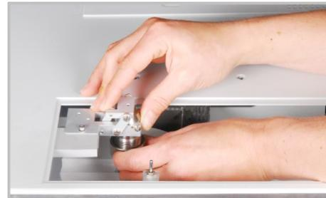
5. Schrauben Sie die Überwurfmutter vom Ofenkopf an der Schleuse vollständig ab.
