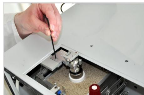
8. Schrauben Sie die Schleuse mit der Innensechskantschraube am Halter fest.
