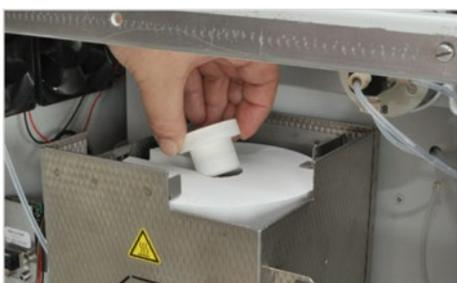
5. Glisser l'élément en céramique dans l'orifice supérieur du four de combustion.
