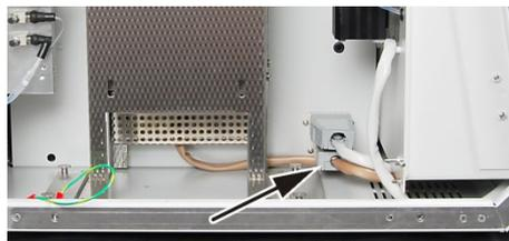
6. Brancher le connecteur du four de combustion dans la prise située en bas à droite sous la paroi arrière de l'appareil.
