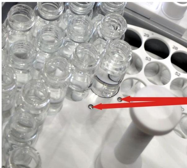
Fig. 53 Points d'ajustage sur le panier à échantillons
