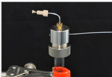
4. Mettre prudemment la tête du four jusqu'à la butée sur le tube de combustion, la pousser légèrement contre le tube de combustion et serrer à la main l'écrou d'accouplement. La tête du four est livrée équipée de la canule du four et de la canule du gaz porteur.
