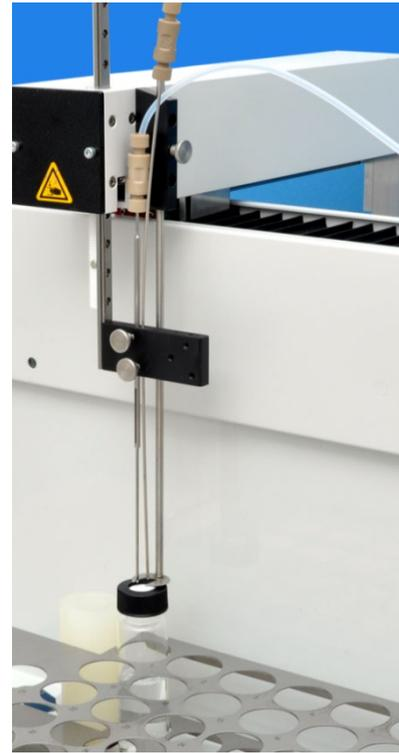
Pour les mesures NPOC avec évacuation non parallèle : insérer les deux canules dans l'emplacement de gauche du porte-canule
