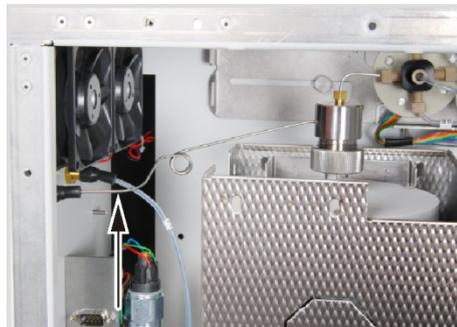
3. Retirer la canule de gaz porteur du connecteur Fast dans la paroi latérale gauche.
