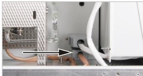
6. Débrancher la prise du four de combustion.
