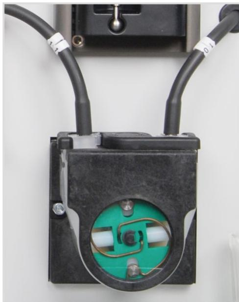
Fig. 8 Pompe de condensat
