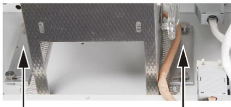
7. Aflojar los tornillos moleteados de los paneles de sujeción del horno en la base del dispositivo. Llevar los paneles hacia fuera.
