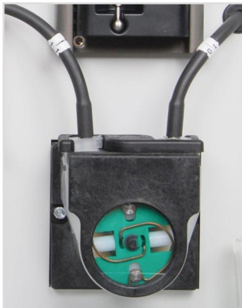
**Imag. 8** Bomba de condensado
