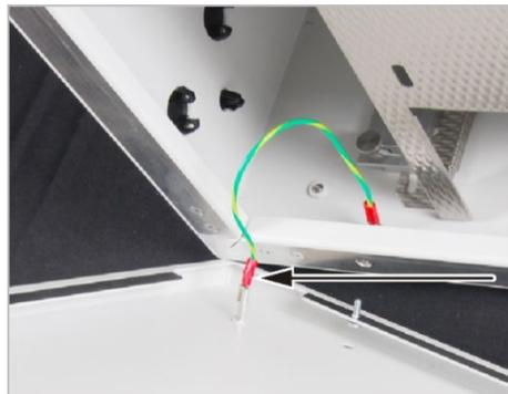
2. Abrir la pared lateral izquierda del analizador. Aflojar los tornillos de sujeción. Los tornillos no se pierden y permanecen en la pared.
