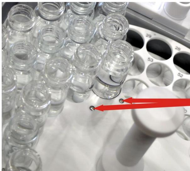
Imag. 53 Puntos de ajuste en la bandeja de muestras
