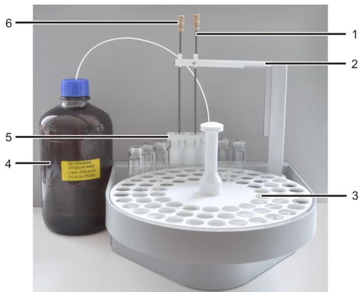
**Imag. 20 Montaje del cargador AS vario ER**
