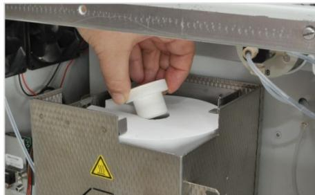
5. Introducir el soporte de cerámica en la abertura superior del horno de atomización.
