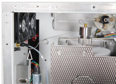
3. Retirar la cánula de gas portador del conector FAST en la pared izquierda.
