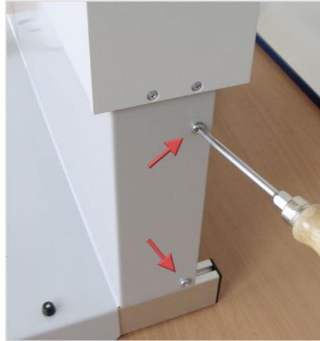
3. Aflojar los tornillos de la cabina del lado derecho del cargador.
