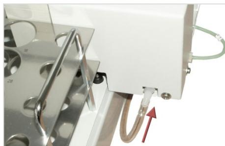
12. Conectar la manguera de desechos en la base de desechos del módulo POC y unirla con el recipiente de desechos correspondiente o con un desagüe.
