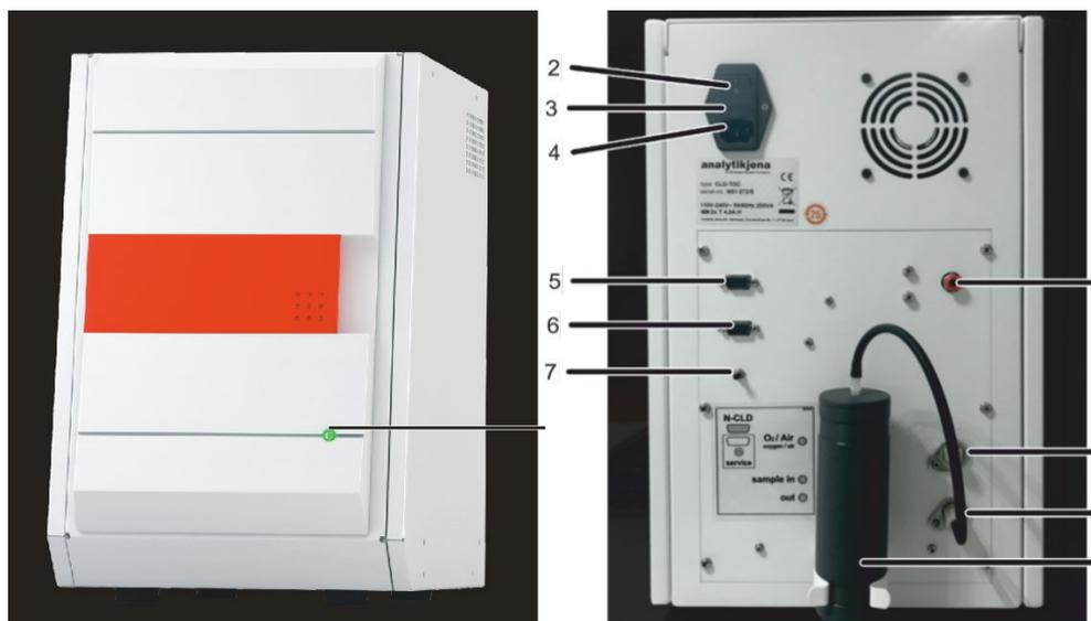
Imag. 41 CLD – Elementos de indicación, conexión de red y conexión de medios
