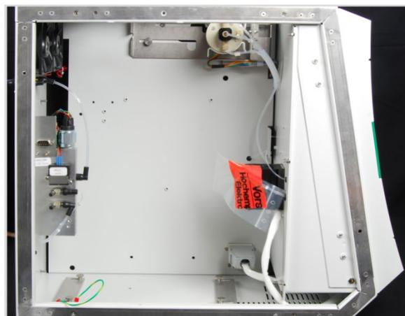
Imag. 58 Horno de atomización desmontado
