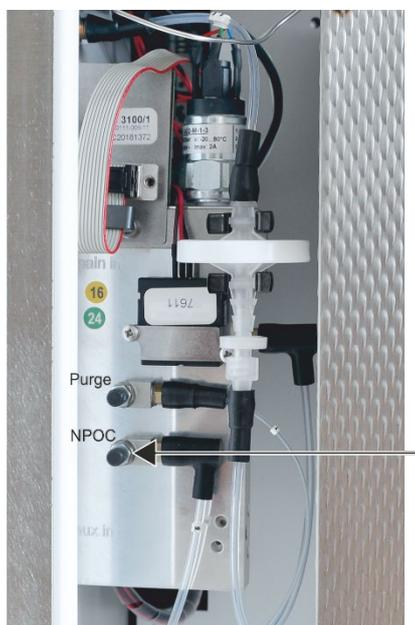
6. Aflojar los tornillos de posición de la válvula de aguja NPOC.
