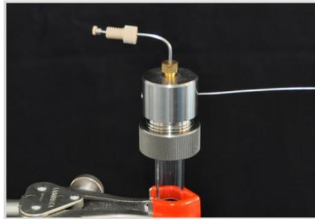
4. Colocar la cabeza del horno con cuidado hasta el tope del tubo de atomización, presionarlo ligeramente en dirección contraria y ajustar la tuerca de unión firmemente.
