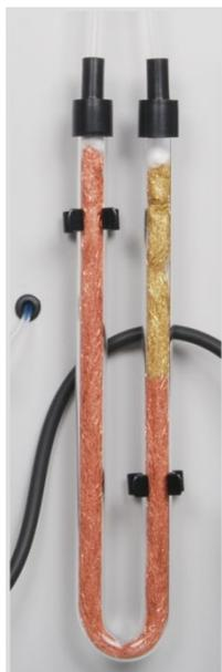
Imag. 14 Trampa de halógeno
