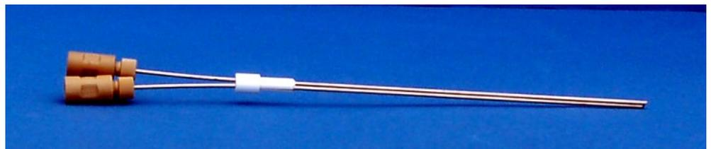
Imág. 22 Manguito con 2 cánulas para mediciones NPOC con purgas no paralelas
