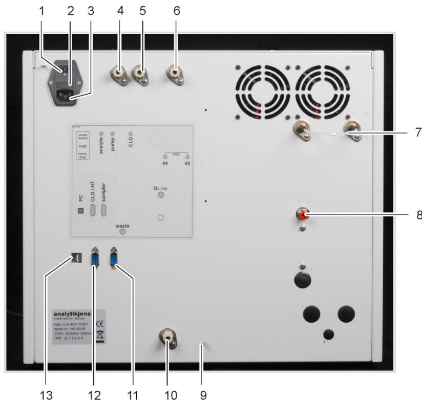
Imag. 60 Conexión de red y conexiones de gas en multi N/C 3100
