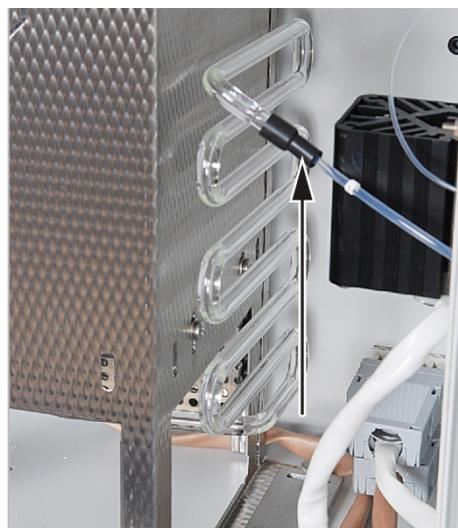
3. Retirar la manguera 1 del conector rápido del serpentín de condensación.
