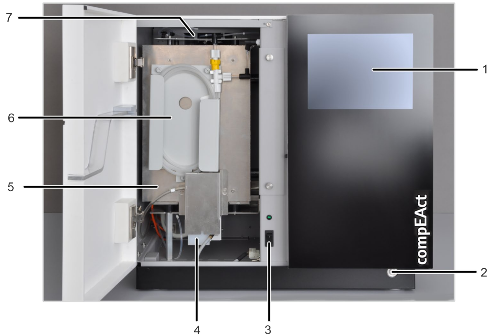
Fig. 3 Composants principaux du compEAct S
