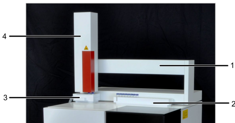
Fig. 11 Passeur d'échantillons LS
