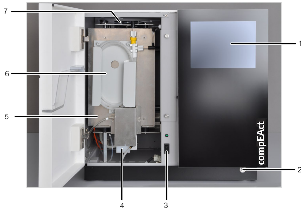
Fig. 3 Componentes principales del compEAct S
