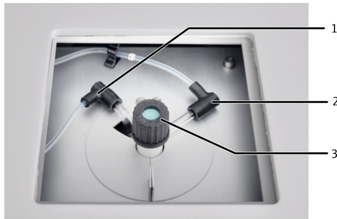
Fig. 5 Conexiones en el tubo de combustión
