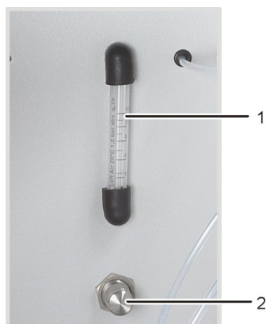
Figure 28 Régulateur de débit pour le courant d'oxygène
