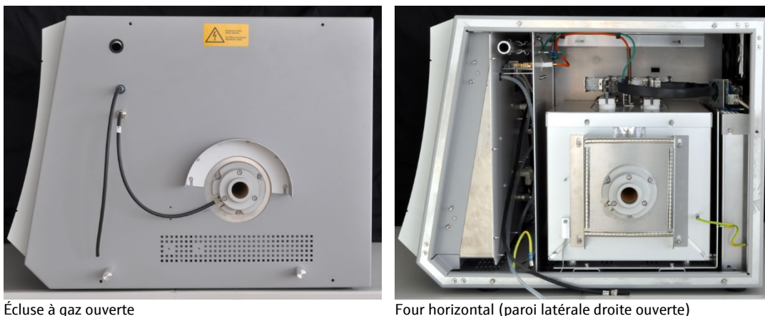
Figure 1 Écluse à gaz et four horizontal de l'appareil de base multi EA 4000
