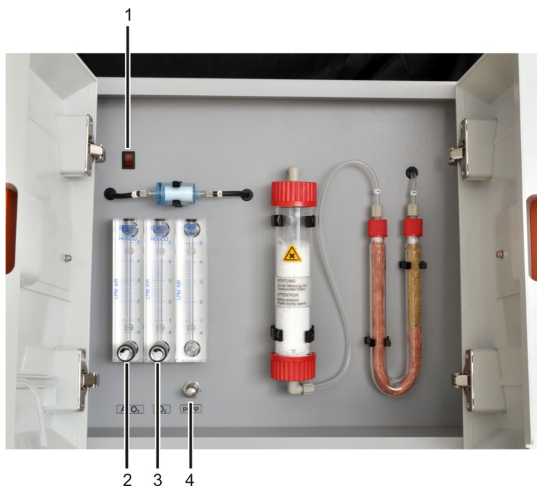
Fig. 7 Elementos de manejo detrás de las puertas frontales del multi EA 4000
