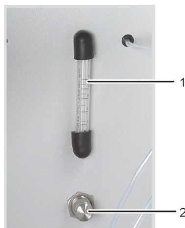
Fig. 28 Regulador de flujo para el flujo de oxígeno
