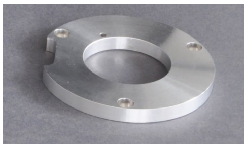
Fig. 45 Pieza de acoplamiento para mediciones de Cl
