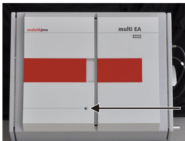
Fig. 6 Luz de estado en el equipo base multi EA 4000
