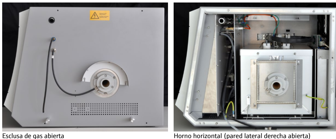
Fig. 1 Esclusa de gas y horno horizontal del equipo base multi EA 4000
