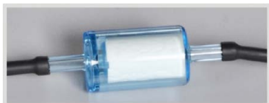
Abb. 22 Staubfilter vor Messgaseingang des C/S-Moduls
