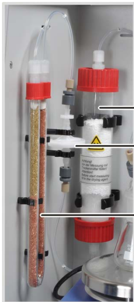
Abb. 28 Komponenten zur Messgastrocknung und -reinigung am Manuellen TIC-Feststoffmodul
