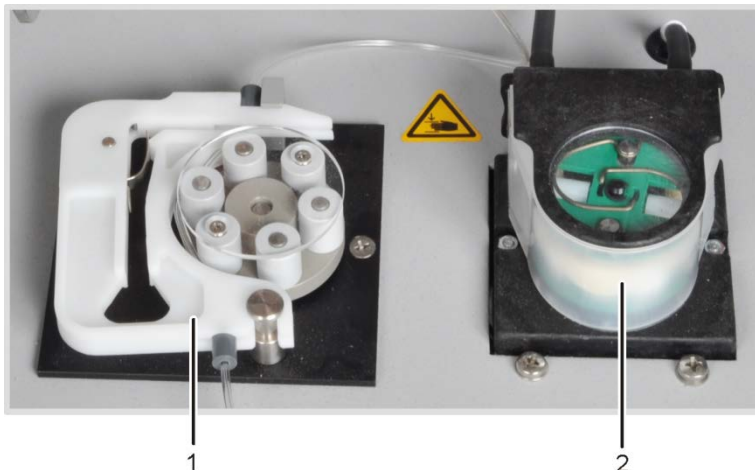
Abb. 20 Schlauchpumpen am Automatischen TIC-Feststoffmodul
