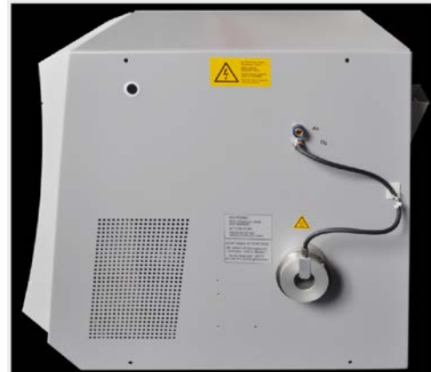
Écluse à gaz ouverte
