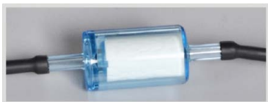
Illust. 22 Piège à poussières avant l'entrée de mesure du module C/S
