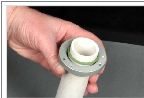
Fig. 31 Elementos para la conexión del reactor de TIC y el tubo de cerámica
