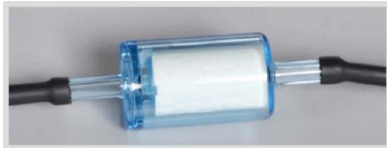
Fig. 22 Trampa de polvo delante de la entrada del gas de medición del módulo de C/S
