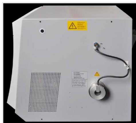
Trampa de gas abierta
