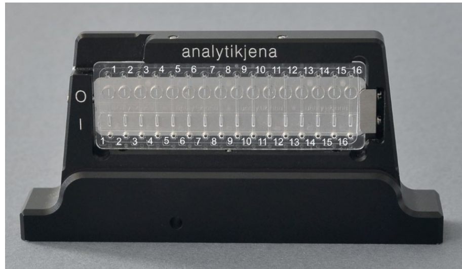
Bild 5 CHIPCUVETTE, im Adapter eingesetzt
