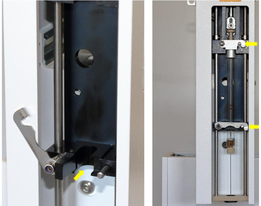
Fig. 24 Adaptateur de seringue et languettes de verrouillage.
