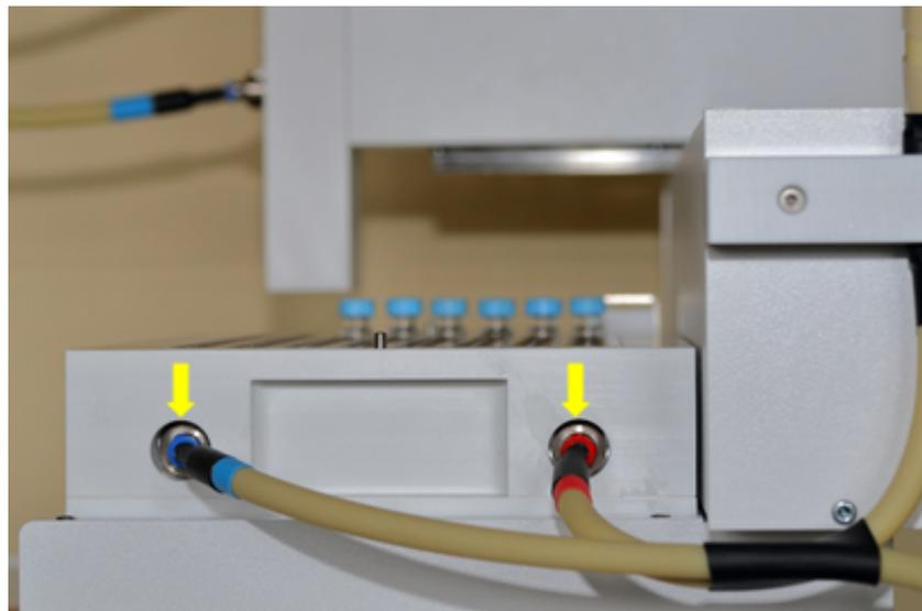
**Fig. 23 Raccord sur la tablette porte-échantillons thermostatisable**
