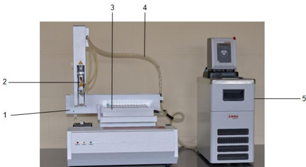
**Fig. 1** Distributeur d'échantillons thermostatisable (placé sur l'ABD)
