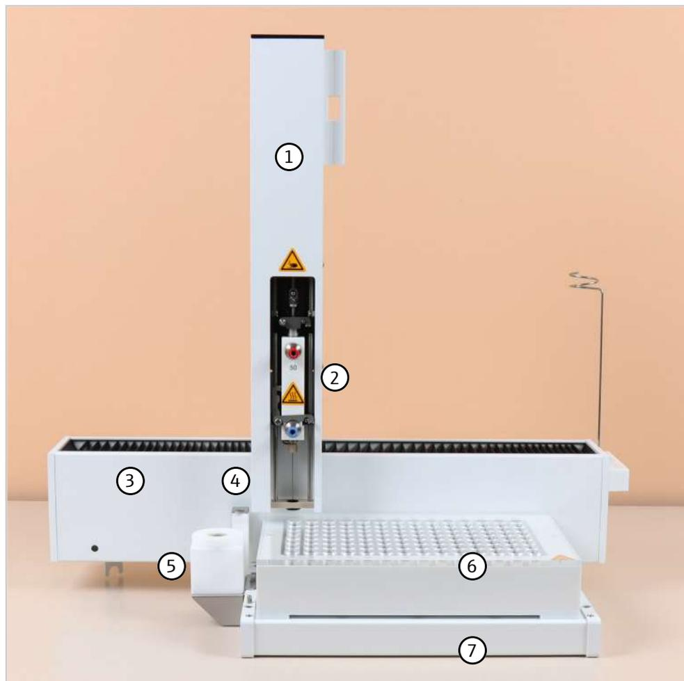
**Fig. 2 Composants principaux du distributeur d'échantillons**
