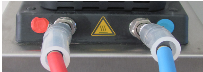
Fig. 19 Termostato: conexiones en la parte trasera
