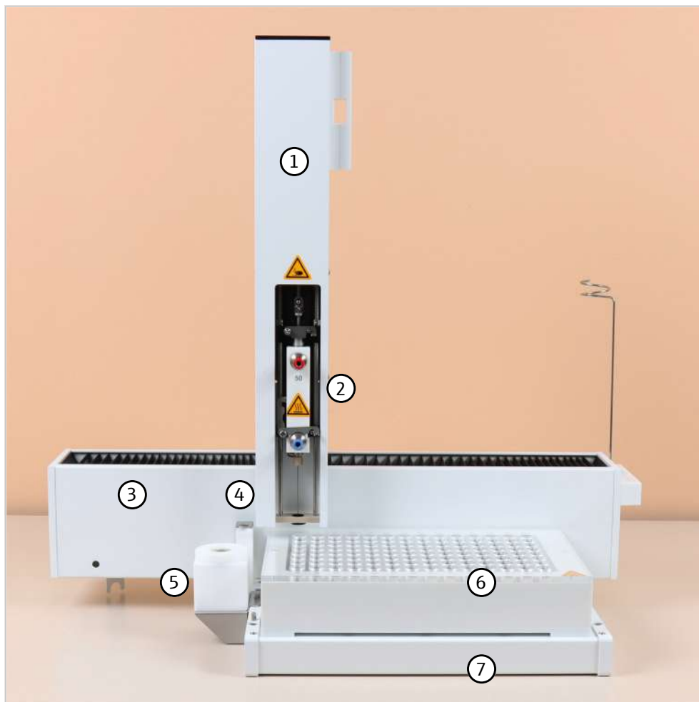
Fig. 2 Principales componentes del automuestreador
