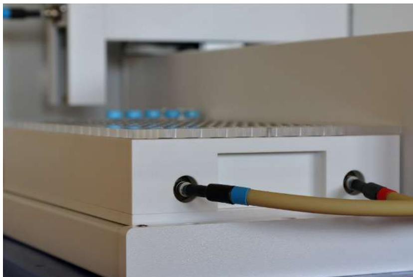
Fig. 17 Bandeja de muestras calefactable: conexiones
