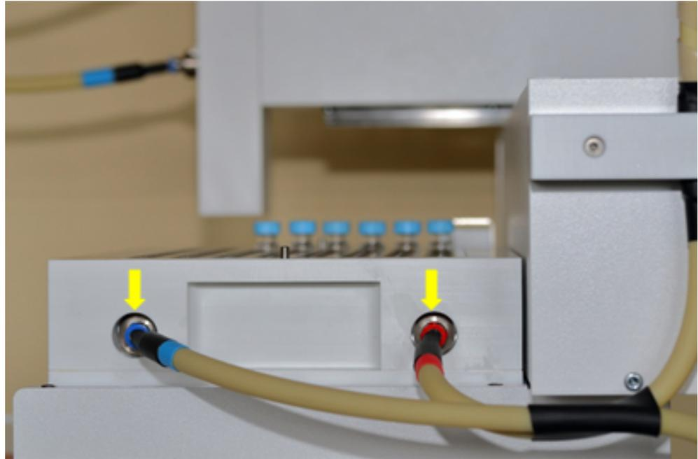
Abb. 23 Anschluss am temperierbaren Probenblett
