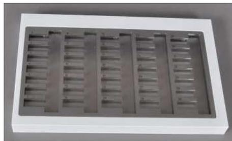
Abb. 15 Probentablett für Feststoffe und AOX-Proben
