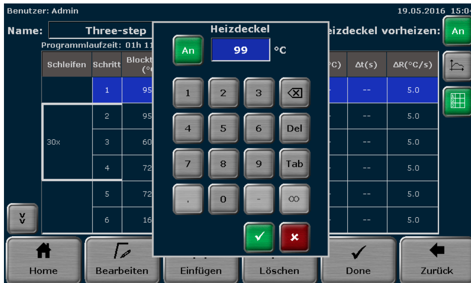
Abb. 19 Biometra TOne Bildschirm zur Festlegung der Heizdeckeltemperatur
