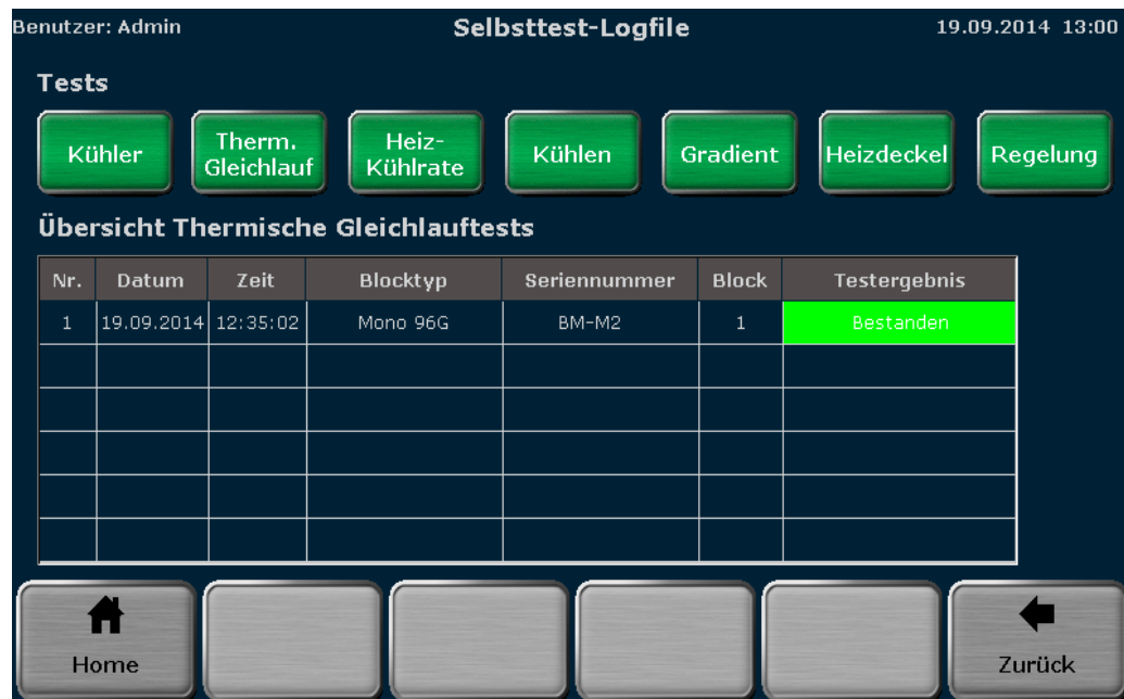
Abb. 57 Biometra TOne Bildschirm zum ausführlichen Selbsttest Logfile (Extended Self-Test Logfile)
