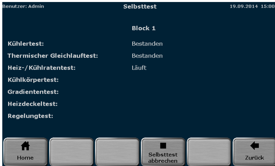
Abb. 61 Biometra TOne Bildschirm mit Übersicht zum ausführlichen Selbsttest
