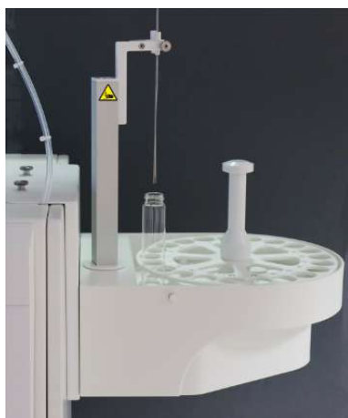
Изобр. 4 Автосамплер, прикрепленный к анализатору с помощью держателя
