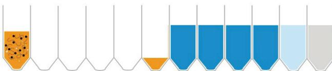
Bei der externen Lyse wird zuerst der Mix aus lysierter Probe und der MAG-Suspension durch Auf- und Abpipettieren homogenisiert. Anschließend erfolgt der Transfer des Bindepuffers auf die Probe.
