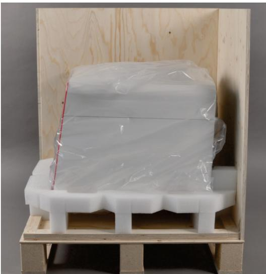
11. Den InnuPure C16 *touch* zum Schutz vor Kratzern in die Plastiktüte einhüllen und in die Verpackungskiste heben.
