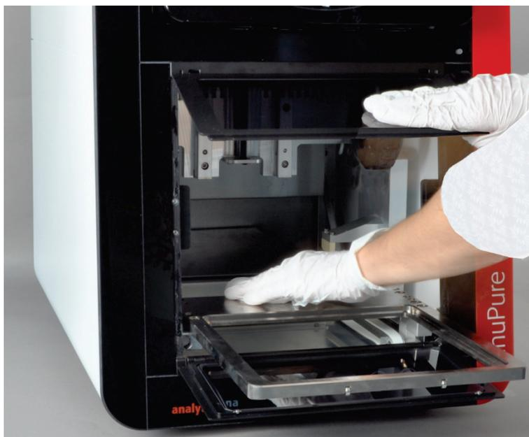
Abb. 23 Wischdesinfektion mit geöffneten Fronttüren
