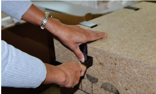
Zum Entfernen der Klammer das Werkzeug unter die hochgebogene Seite der Klammer schieben und die Klammer vorsichtig abheben. Die Klammer dabei mit einer Hand festhalten!
