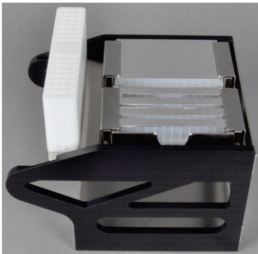
5. Die Niederhalter herunterklappen, so dass die Plates und Strips während des Extraktionsprozesses nicht aus dem Probenblock gezogen werden.
