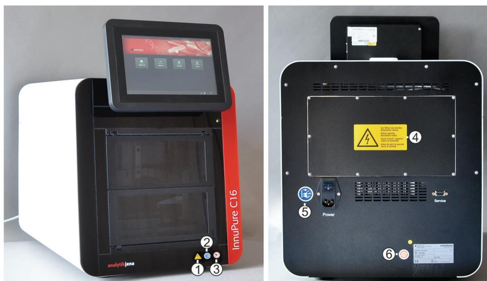
Abb. 1 Sicherheitskennzeichnungen und Hinweissymbole an Front- und Rückseite
