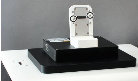
5. Das Tablet auf der Oberseite des InnuPure C16 touch befestigen.
