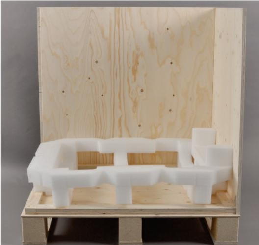
9. Zwei Seitenwände an die Palette montieren.
