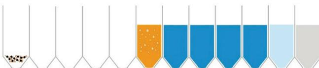
Während des nächsten Schrittes wird die Magneteinheit an den Boden der Arbeitskavität herangefahren. Die Magnetpartikel mit den gebundenen Nukleinsäuren werden durch das Magnetfeld am Boden der Arbeitskavität fixiert.
