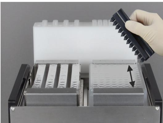
7. Alle Kavitäten in den Strips und Plates mit dem Piercing-Werkzeug.
