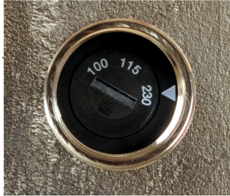
Abb. 9 Spannungswahlschalter auf der Unterseite des Gerätes
