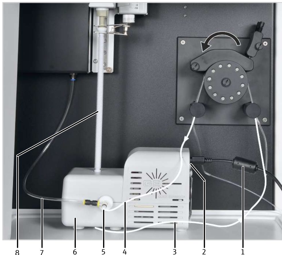
Fig. 26 Instalación de la cámara de pulverización con control de temperatura
