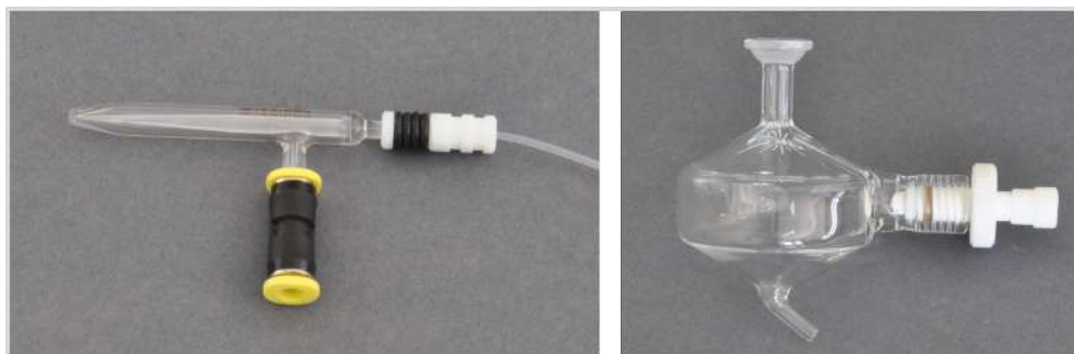
Fig. 5 Pulverizador concéntrico y cámara de pulverización
