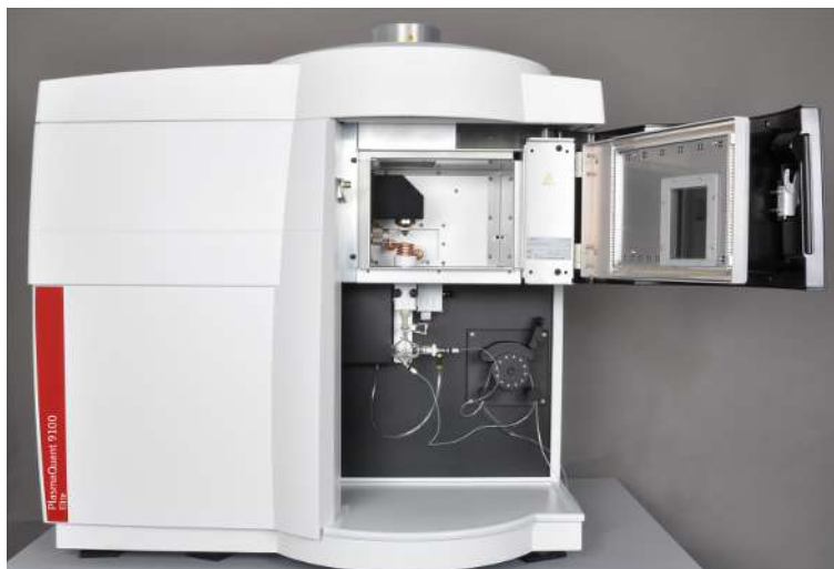
Fig. 1 Espectrómetro de emisión con compartimento de plasma abierto
