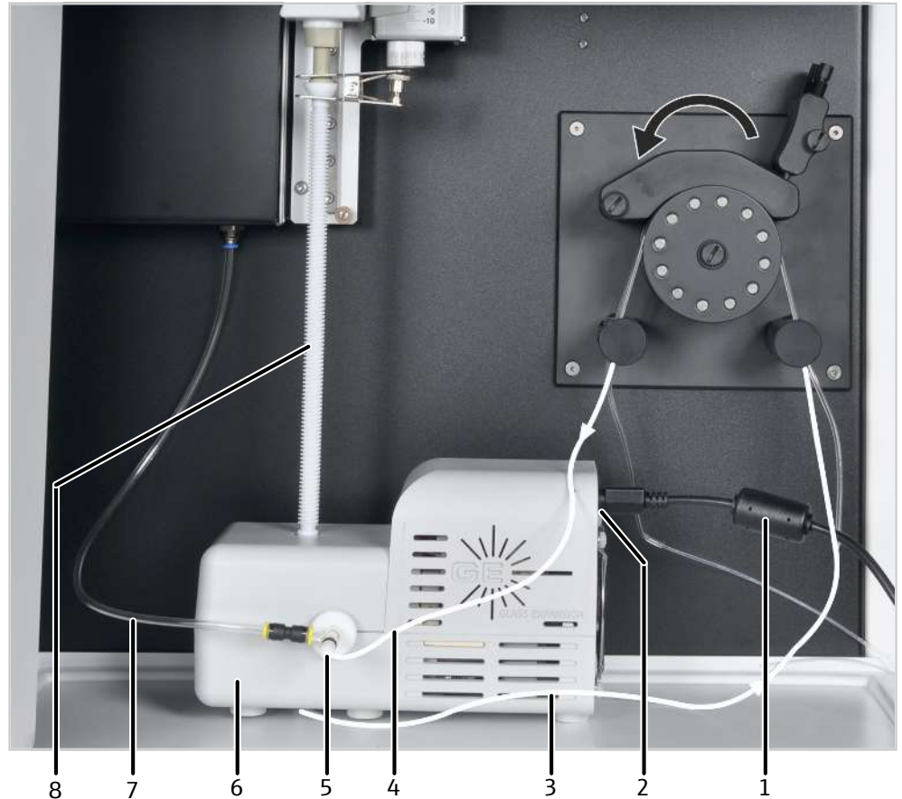
Abb. 26 Temperaturgesteuerte Sprühkammer installieren
