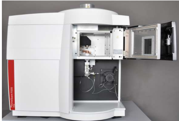
Abb. 1 Emissionsspektrometer, mit geöffnetem Plasmaraum
