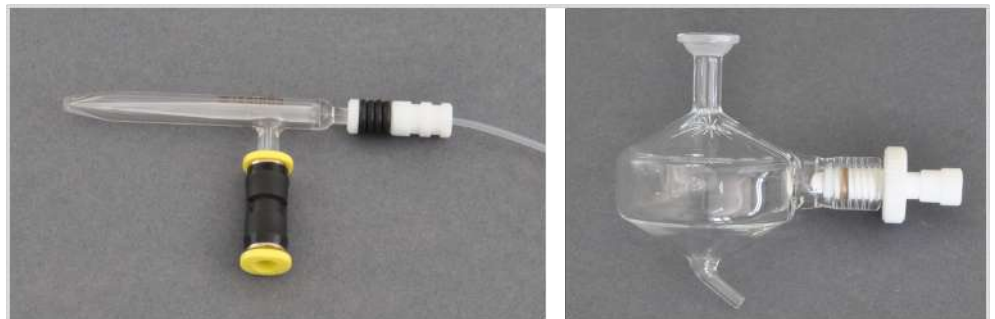
Abb. 5 Konzentrischer Zerstäuber und Sprühkammer
