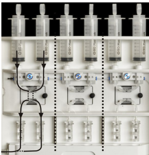
Fig. 2 Sistema de mangueras
