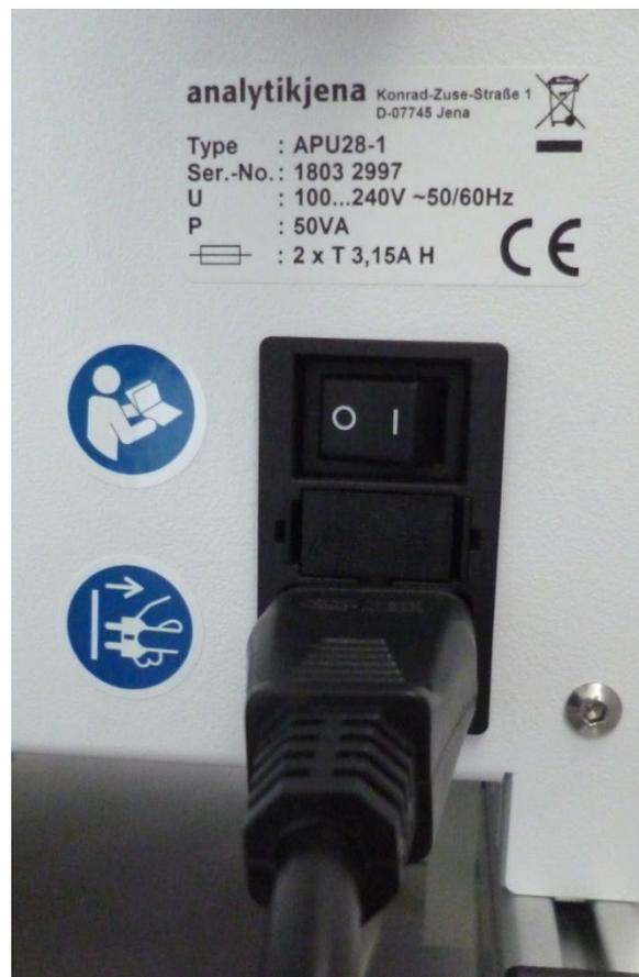
Bild 10 Hauptschalter an der Geräterückseite
