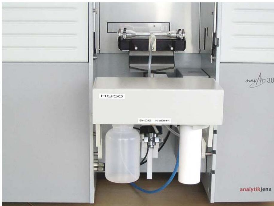
Рис. 2-1 Устройство, HS 50, установленное в povAA 300
