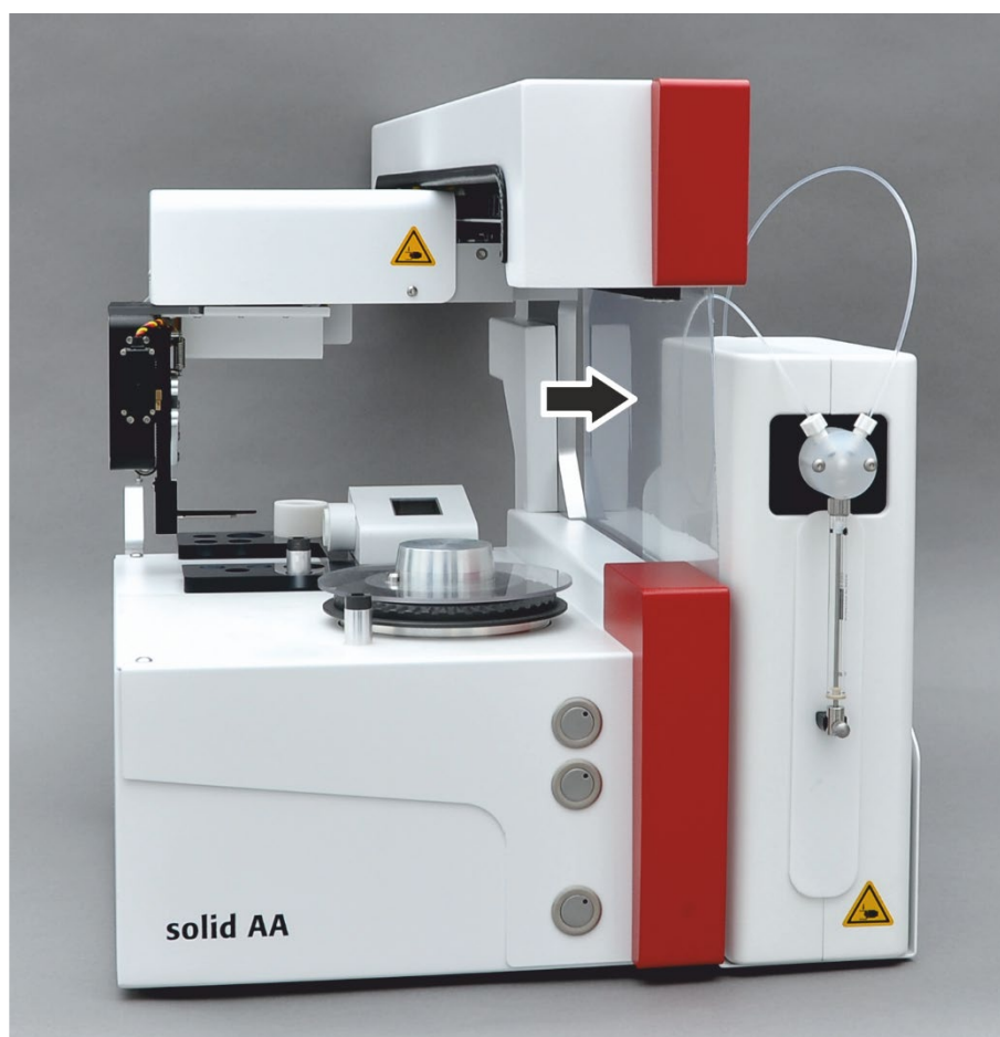
Imagen 21 Lámina protectora en el SSA 600 (flecha)
