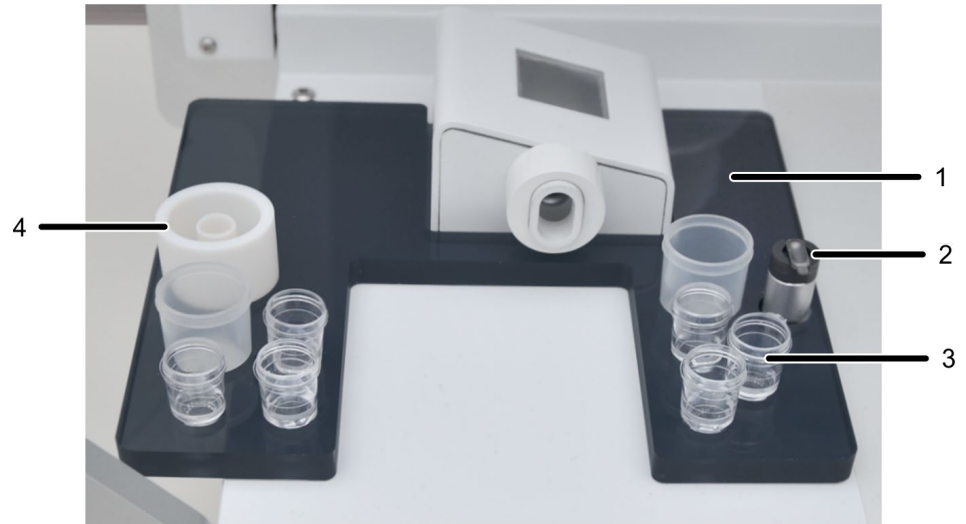
Bild 6 Probenhalter für Flüssigdosierer
