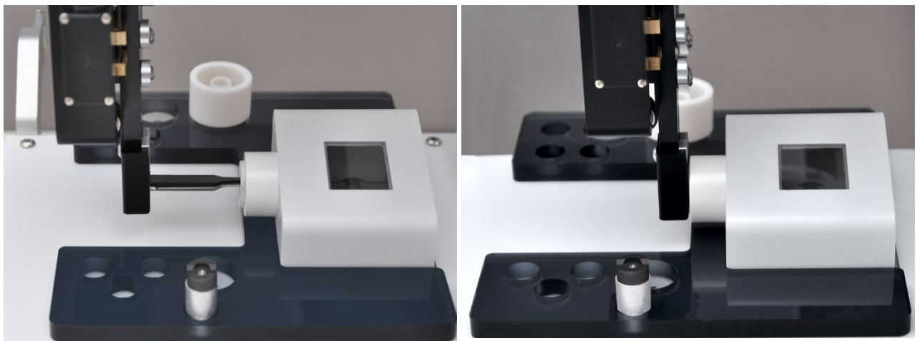
Bild 5 Waage mit Windschutzhaube und Probenschleuse
