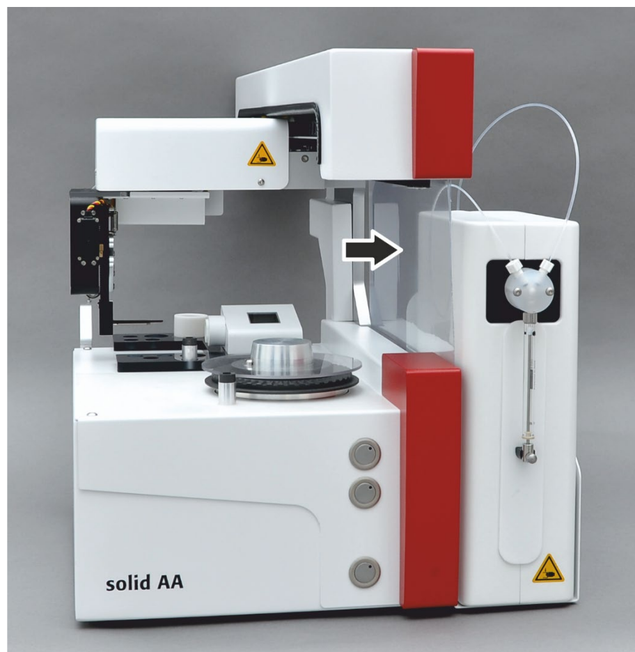
Bild 21 Schutzfolie am SSA 600 (Pfeil)
