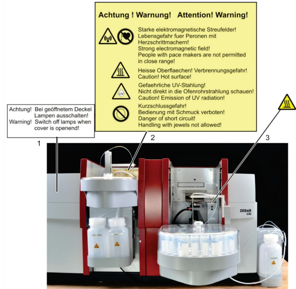
Fig. 1 Panneaux d'avertissement sur le ZEEnit 700 P
