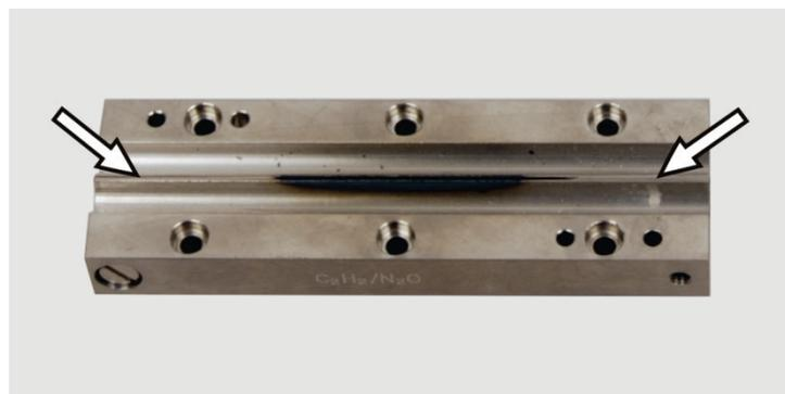
Fig. 64 Plaques d'écartement insérées dans les mâchoires du brûleur
