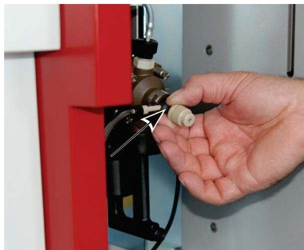
Fig. 61 Retrait du nébuliseur hors de la chambre de mélange
