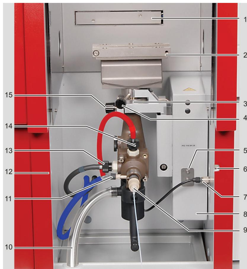
Fig. 39 Raccordements au système brûleur / nébuliseur
