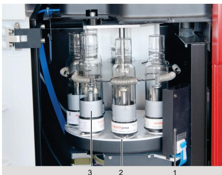
Fig. 18 Structure de la tourelle à lampes
