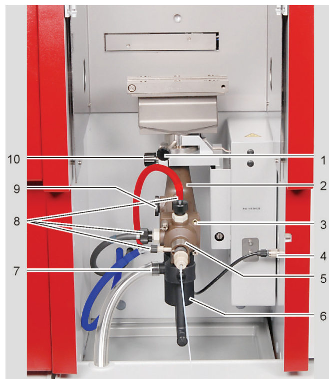
Imag. 59 Desmontaje del sistema pulverizador de quemador
