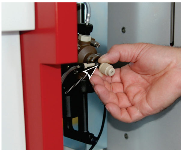
Imag. 61 Extracción del pulverizador de la cámara de mezclas
