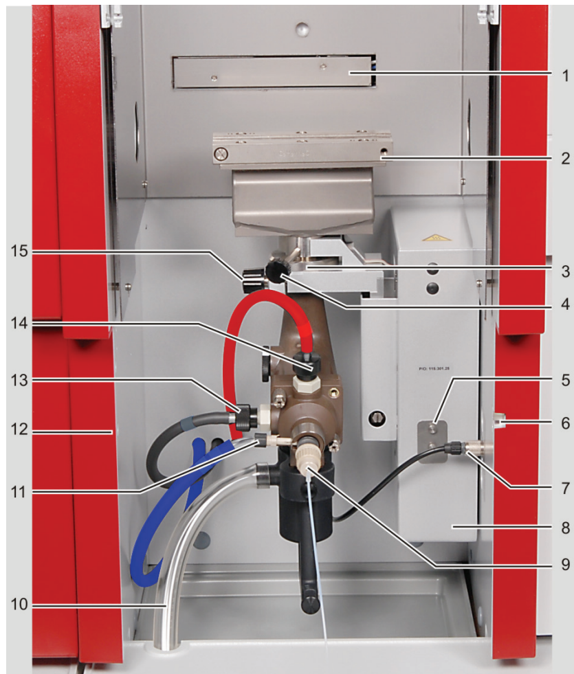
Bild 39 Anschlüsse am Brenner-Zerstäubersystem
