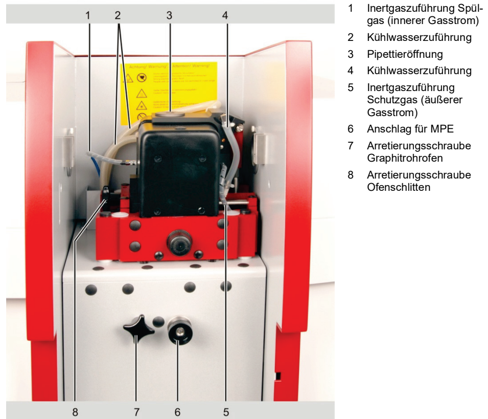
Abb. 37 Arretierungsschrauben Graphitrohrfen
