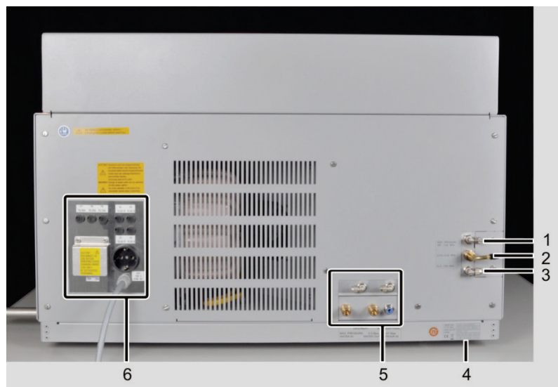
Bild 26 Rückansicht novAA 800 mit Anschlüssen und Sicherungen
