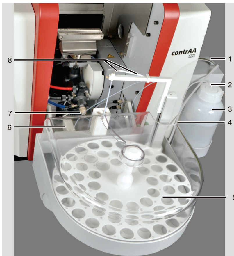
Fig. 44 Atomizzazione mediante fiamma, con campionatore AS-FD e SFS 6
