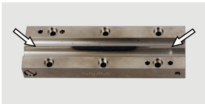
Fig. 61 Piastrine distanziatrici inserite nelle ganasce del bruciatore
