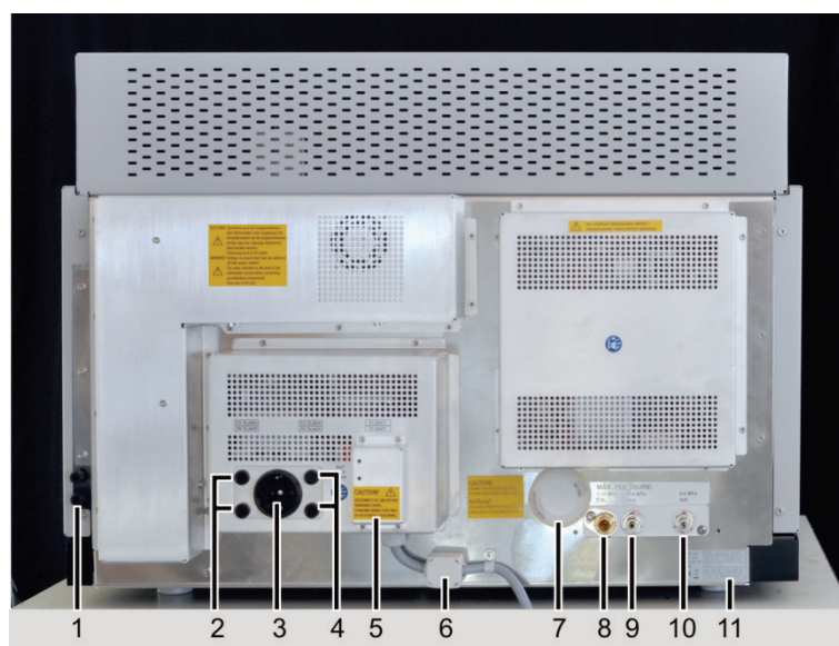
Fig. 27 Vista posteriore contrAA 800 D con collegamenti e fusibili
