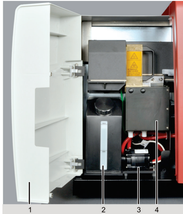
Fig. 51 Contenitore dell'acqua di raffreddamento nel vano lampada
