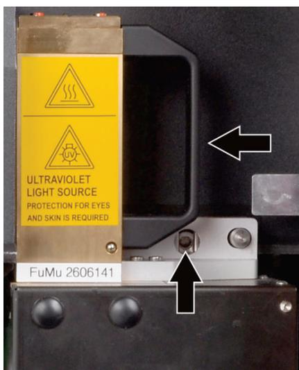
4. Desatornille completamente con la llave de hexágono interior de 5 mm (incluida) el tornillo de fijación horizontal de la cabina de la lámpara,
