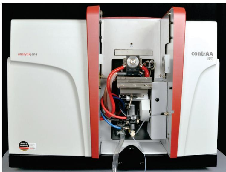
Fig. 8 Compartimento de muestras del contrAA 800 D
