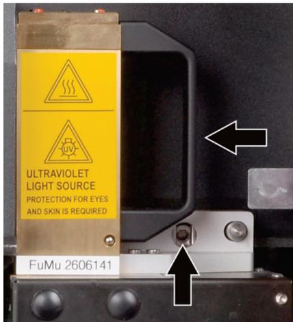
6. Desatornille completamente con la llave de hexágono interior de 5 mm (incluida) el tornillo de fijación horizontal de la cabina de la lámpara,
