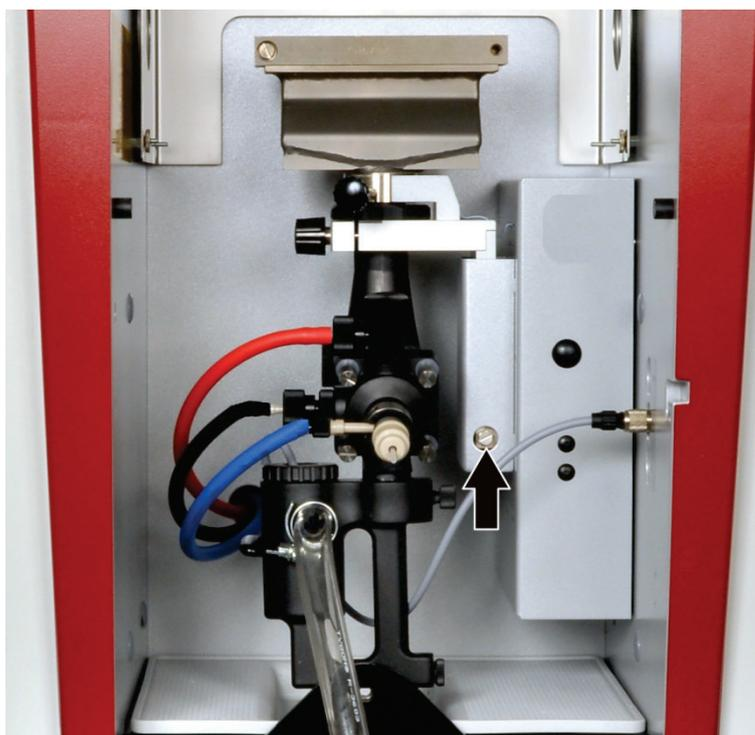
Fig. 52 Tornillo de ajuste para la alineación de la unidad de atomización
