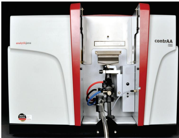
Fig. 9 Compartimento de muestras del contrAA 800 F
