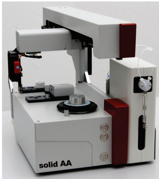
Abb. 19 Feststoffprobengeber SSA 600 und SSA 6z
