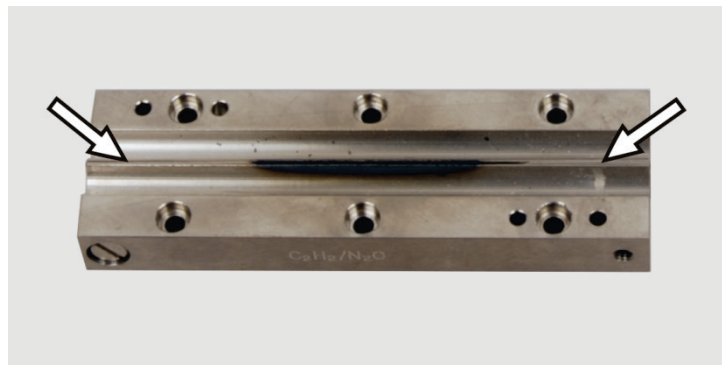
Abb. 61 Distanzplättchen in Brennerbacken eingesetzt
