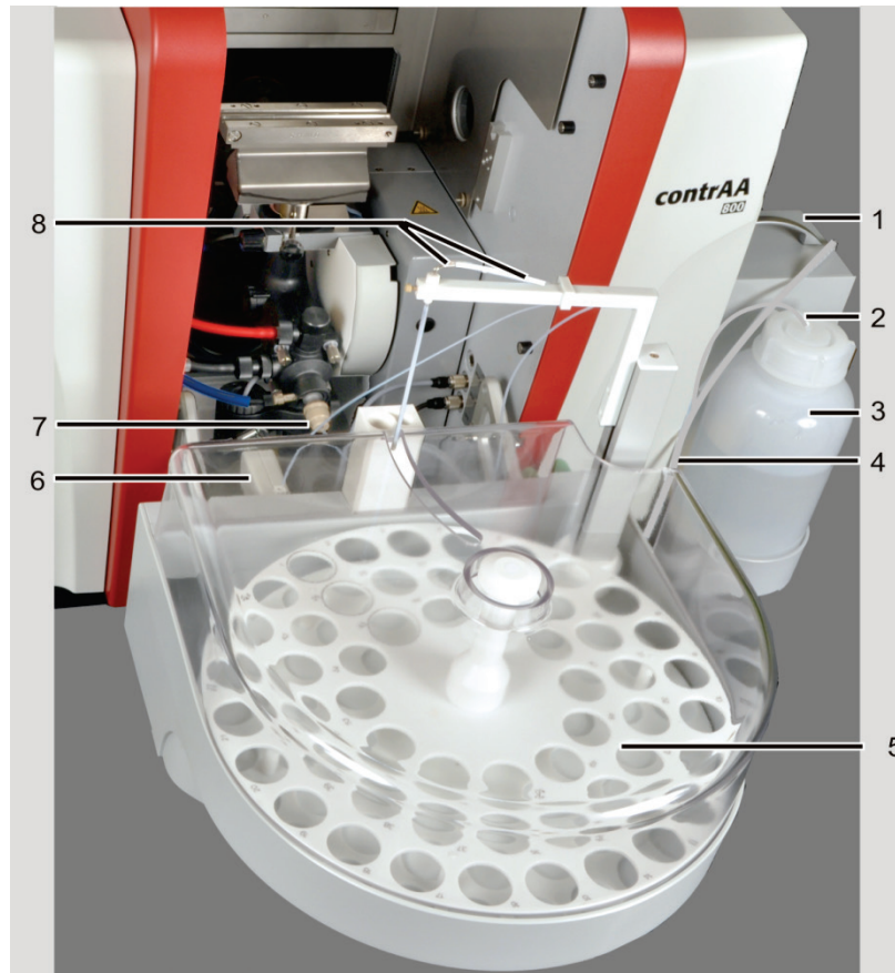
Abb. 44 Flammentechnik, mit Probengeber AS-FD und SFS 6
