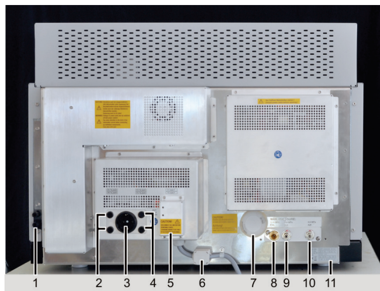
Abb. 27 Rückansicht contrAA 800 D mit Anschlüssen und Sicherungen
